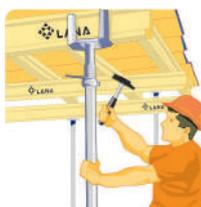
Baisser les poutrelles et les panneaux à l'aide de têtes basculantes et retirer les étais intermédiaires.
