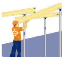
Monter les étais et les poutrelles principales, en utilisant des trépieds et des têtes en U sur les étais pour meilleure sécurité.
